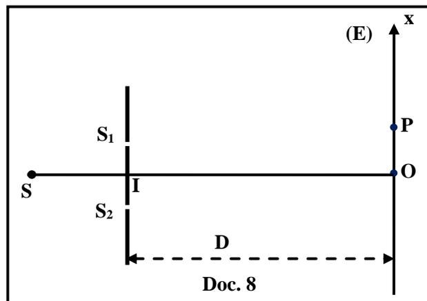
$S_1$  et  $S_2$  sont éclairées par une radiation monochromatique de longueur d'onde  $\lambda = 600 \text{ nm}$  dans l'air provenant de  $S$  qui est placée à égale distance de deux fentes.
