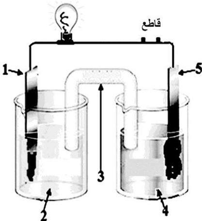
إن الخلية الغلفونية هي خلية كهروكيميائية تنتج الطاقة الكهربائية انطلاقاً من التفاعل أكسدة - اختزال التلقائي الذي يحصل في الخلية.
